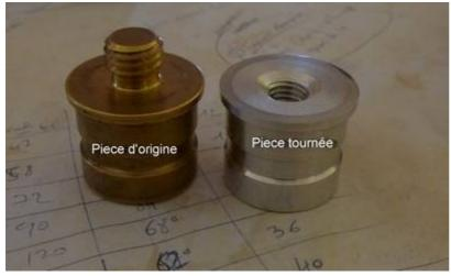
Réduire au tour la partie inferieure de la plaque manfrotto 208 a un diamètre de 12mm
