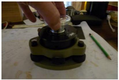
Bloquer l'insert sur l'embase a l'aide de la vis de pression
