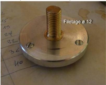
Tarauder a l'axe de l'insert alu ou laiton en faisant attention a l'orthogonalité du filetage de 12mm Assembler par vissage l'insert et la plaque Manfroto 208 modifiée
