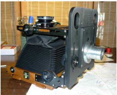
Monter l'ensemble chambre – insert sur l'embase installée sur le pied
