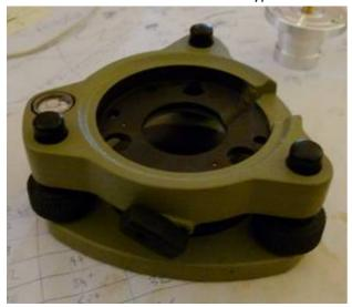
1 adaptateur rotatif pour embase type SECO 2070
