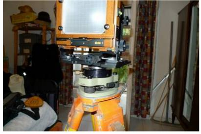
La vis de l'adaptateur permet la rotation ou le blocage
