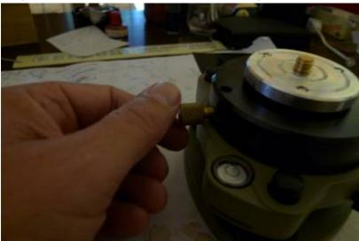
$Monter\ l'ensemble\ embase-adaptateur-plaque\ sur\ le\ trépied\ GST20$
